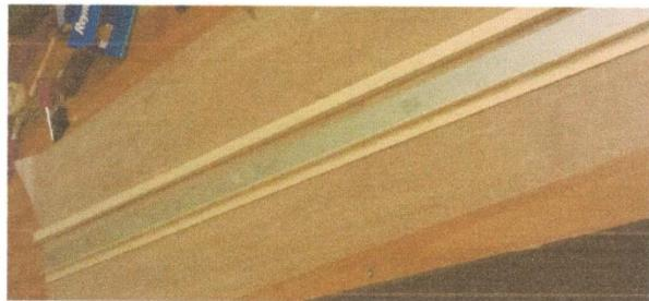
Необходимо подготовить рабочее место. На столе должна лежать вощеная бумага (она понадобится для защиты бальзовых полос от попадания клея). Учащиеся используют двухсторонний скотч в качестве направляющей для соединения брусков на вошеной бумаге. Бумага служит в качестве направляющих для склеивания двух брусков в балку. Дети кладут одну полосу бальзы вертикально перед собой, а затем рядом кладут другую.
