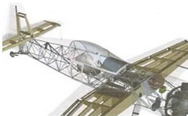
У большинства авиамоделей каркас собирают из продольных и поперечных элементов, воспринимающих нагрузки и образующих внутренний объем. К продольным элементам относятся лонжероны и стрингеры, к поперечным – балочная конструкция. Часто каркас изготавливают в виде пространственной фермы. Но есть каркасы и смешанные, например, передняя часть в виде фермы, а задняя – балочная и наоборот.
