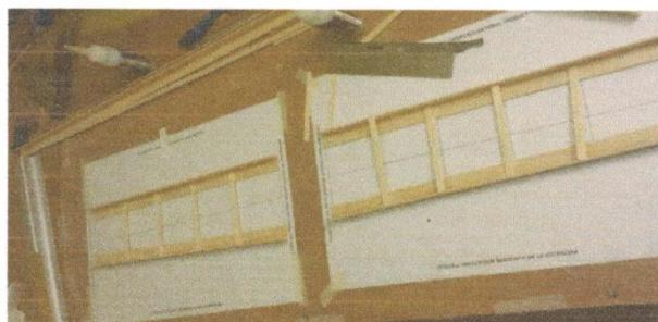
Установка вертикальных элементов, изготовленных из пробкового дерева, в соответствии с заранее подготовленным эскизом. К рабочей поверхности вместе с вошеной бумагой приклеивается чертеж, и с помощью двухстороннего скотча скрепляются угловые элементы фермы в заданных местах.
